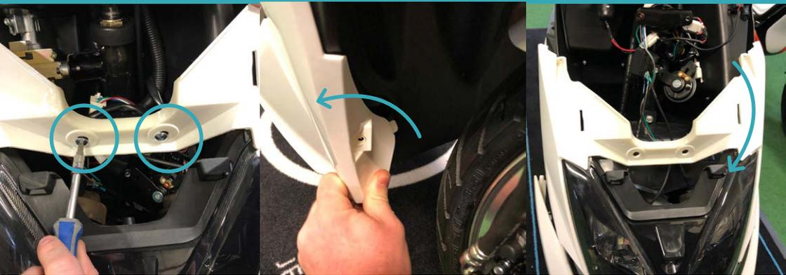
4. Finissez de dévisser les deux grandes vis centrales, détachez la face avant et posez-la délicatement sur le garde-boue. Attention à ne pas tirer les câbles.
