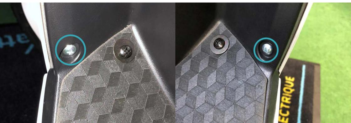
1. Pour accéder au neiman, il sera nécessaire de démonter le carénage de la face avant. Commencez par dévisser les vis présentées ci-dessus.
